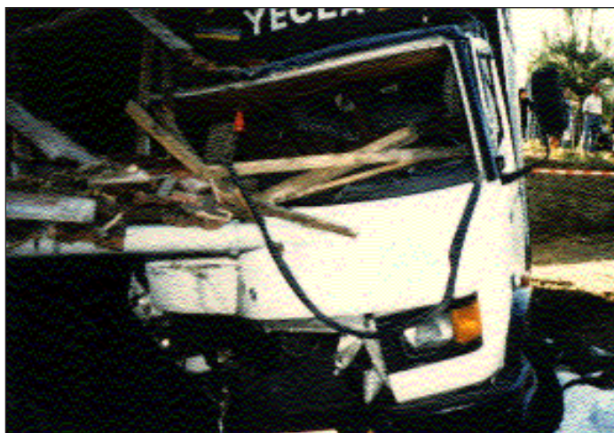
s Fig. 1.- El camión en el que viajaba la víctima. Nótese la extensa deformación e intrusión del lado derecho de la cabina junto al daño, relativamente escaso, de su parte izquierda.
