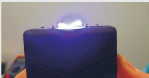
Figura 5. Descarga de una arma DDC con los electrodos al aire.
