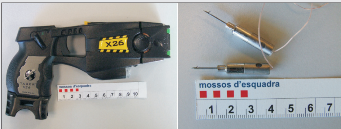
Figura 7. Pistola TASER® X26 (izquierda) y electrodos con forma de arpón (derecha).
